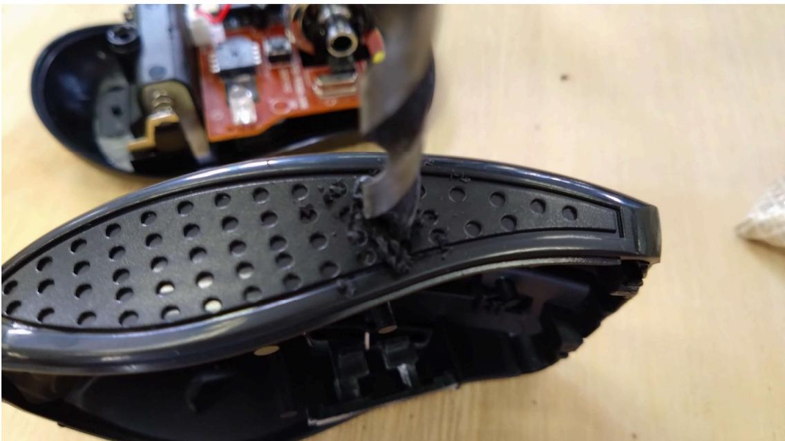
6mmのドリルを使ってジャックを取り付けるホールを開けます。
