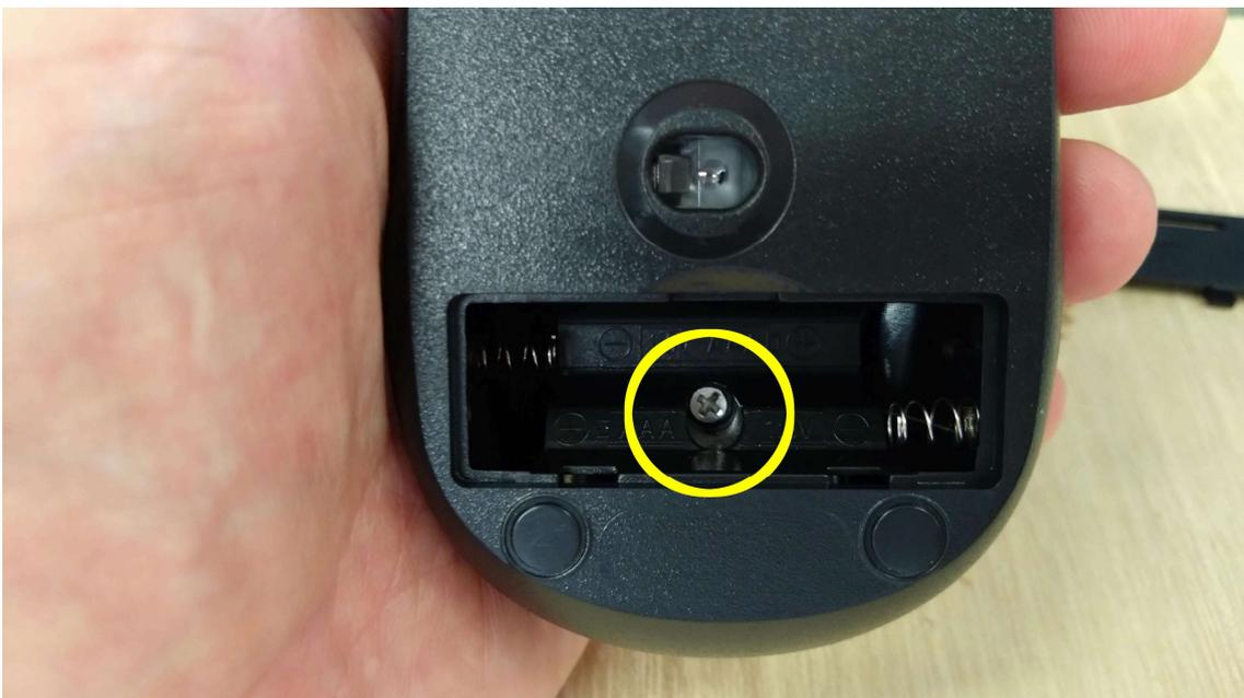
電池ボックスのふたを開けるとビスが見えるのでドライバーで取り除きます。このマウスはこのビス1個を外すだけで簡単に分解ができます。ビスのサイズが小さいので細いドライバーか精密ドライバーがあると外しやすいです。小さいビスなので紛失しないように注意してください。
